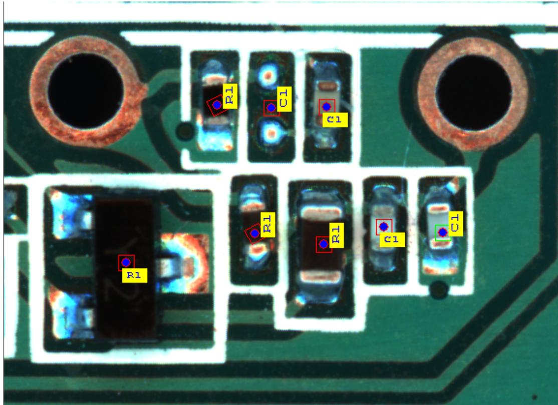
完成导入后，可以看到所有元件框都偏离元件所在的位置，这都是正常情况，因为贴片机的坐标原点与 AOI 的坐标原点不同，我们可以按照以下方式进行调整。
