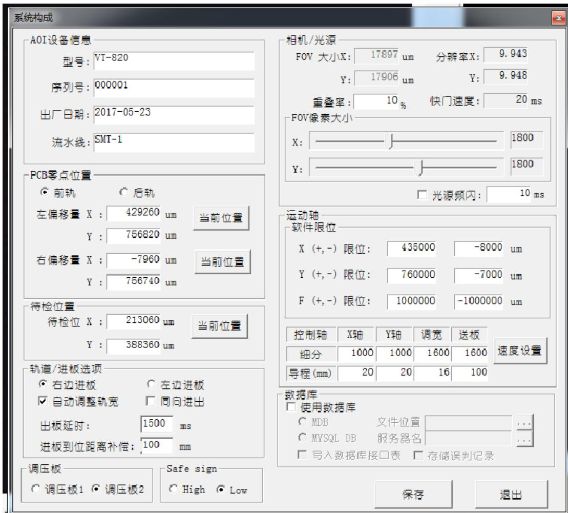
点击菜单 [系统配置] - [系统技术参数], 可设置部分参数:
