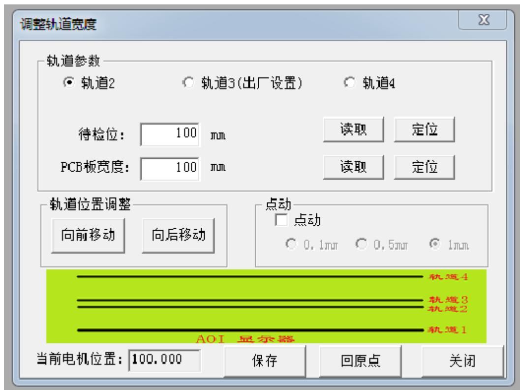
将 PCB 放在轨道进入端，点击底部的「操作」[进板]，PCB 进入轨道中正常检测位置并被固定。
