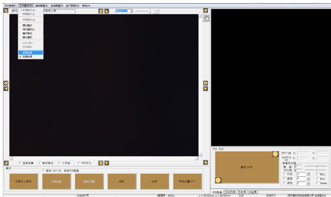
调整 PCB 轨道宽度，按键盘上的上下左右键控制前后轨道宽度的大小，如下图；
