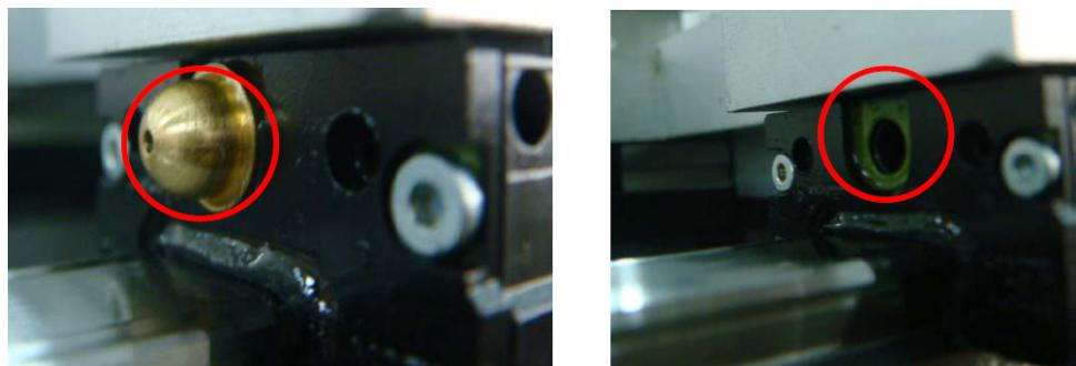
第四步：将注油枪头插入滑块注油嘴，并压紧，轻轻压注油枪压杆，让润滑脂均匀注入滑块之中，并让滑块在导轨上来回滑动，使润滑脂均匀涂入。
