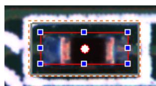
极性框：单框，有极性方向要求的图形；
