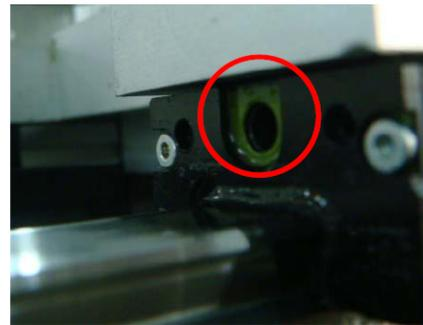
第四步：将注油枪头插入滑块注油嘴，并压紧，轻轻压注油枪压杆，让润滑脂均匀注入滑块之中，并让滑块在导轨上来回滑动，使润滑脂均匀涂入。
