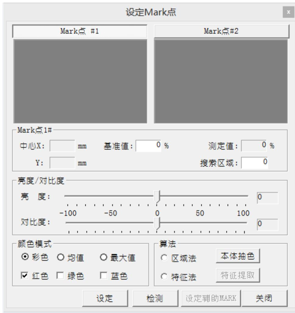
在 Mark 点#1 里，用鼠标左键拖动框选出 PCB 斜角的其中一个 Mark 点，点击设定，并可配合调节亮度/对比度、颜色模式，让 Mark 点图像的轮廓清晰。点击 Mark 点#2，切换设置另一斜角的 Mark 点，最后如以下时点击右下角 [关闭]。
