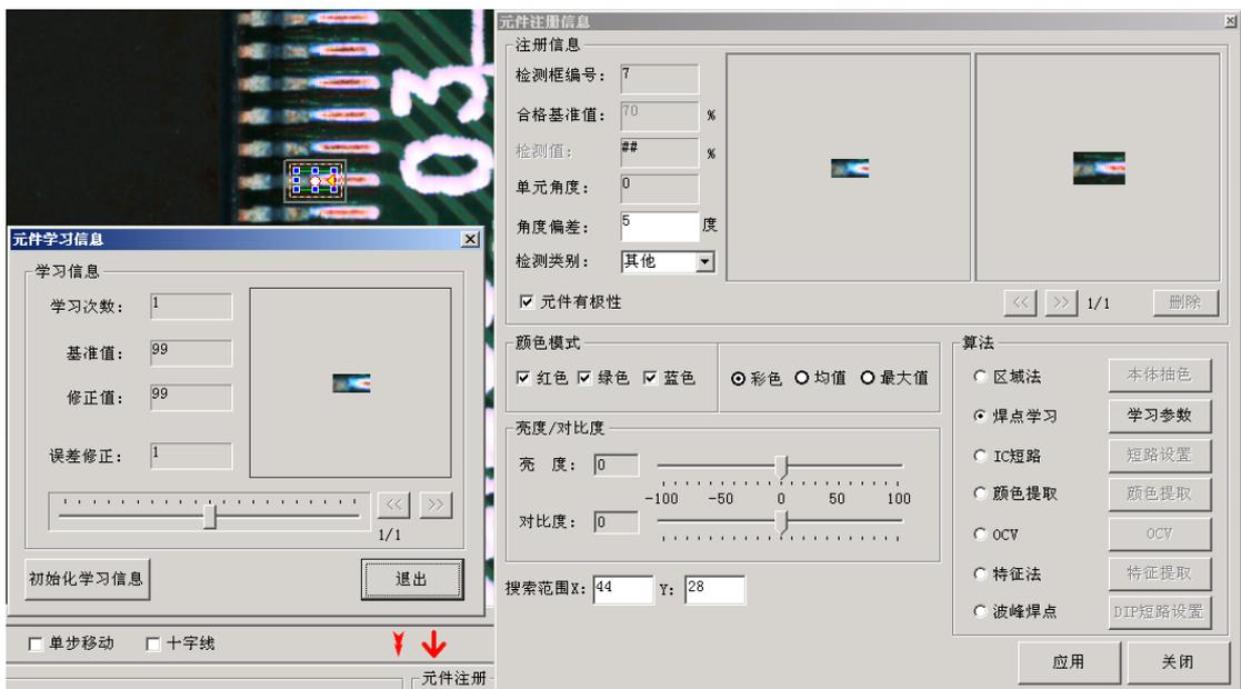
IC 短路：适用于如 IC 引脚等多个同样形状的元素脚间连锡或异物。
