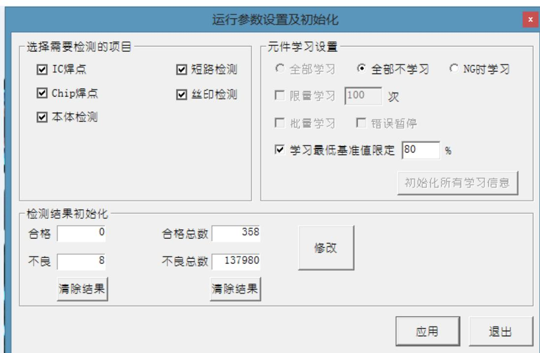
检测完成后弹出检测结果，用键盘的→键选中到单个图像框，确认 [NG 元件图像] 与 [注册元件图像] 略有差异，但也可作为良品标准图像，点击 [添加组] 在弹出的框内重新画好元件框并点击 [确定]，此后 [NG 元件图像] 处的这一个图像就添加为良品标准图像。
