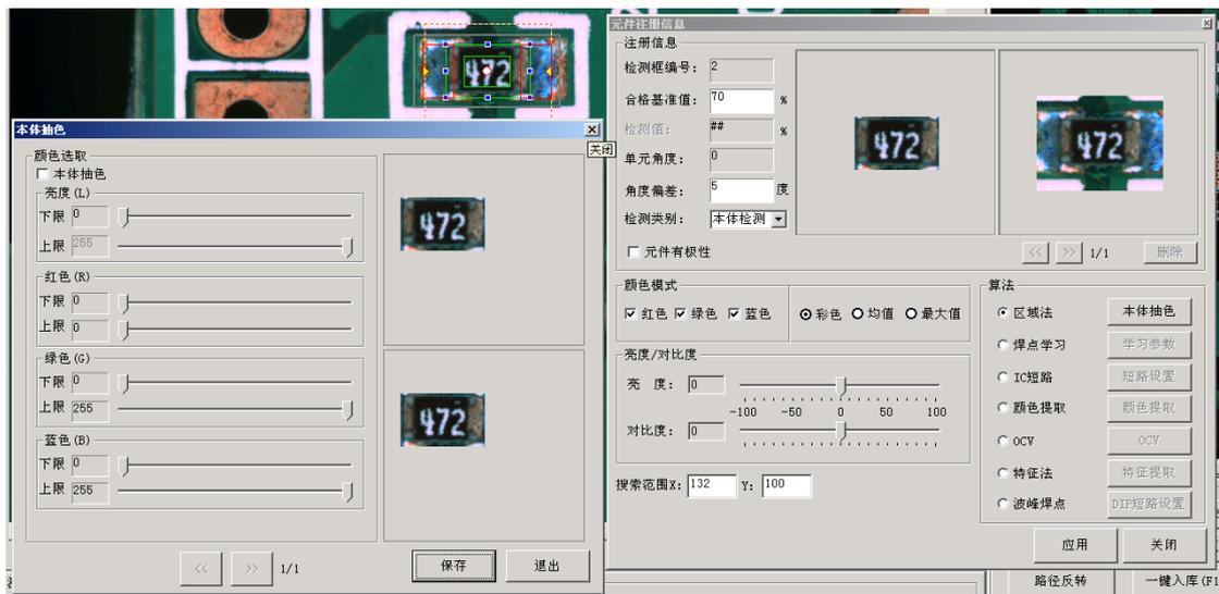
焊点学习：适用于密集型 IC 引脚的焊点：
