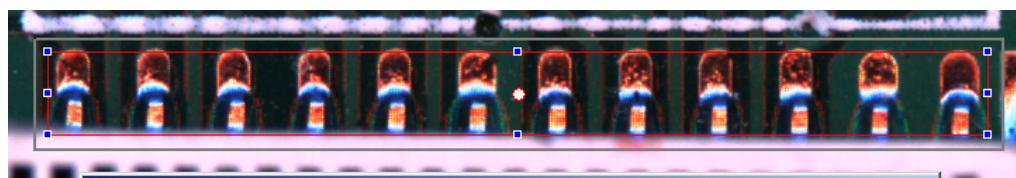
RC 单框： 电阻或电容用一个框检查，包含本体和两端焊锡的范围；
