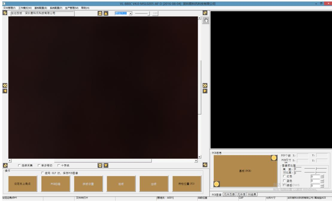
将 PCB 放在轨道进入端，点击底部的 [操作] [进板]，PCB 进入轨道中正常检测位置并被固定。
