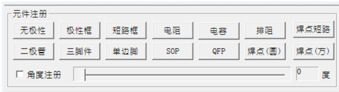
**无极性单框：**一般勾画所有规格在 0402 以内的无极性的电容和电阻的检测框。也可以做其他元件的本体标注的检测框。
