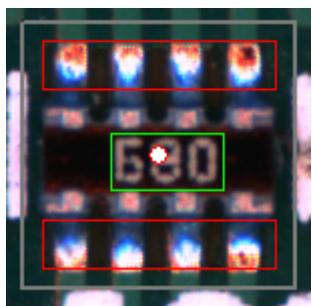
画出的元件框，可以直接调试标准值，用鼠标左键点击元件框使其处于选中状态，再点击图像，出现对话框〔元件注册信息〕。
