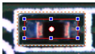
极性框：单框，有极性方向要求的图形；
