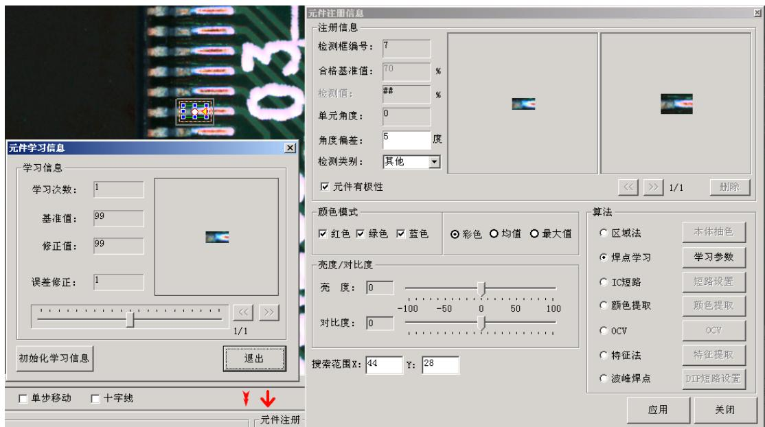
**IC 短路：**适用于如 IC 引脚等多个同样形状的元件脚间连锡或异物。
