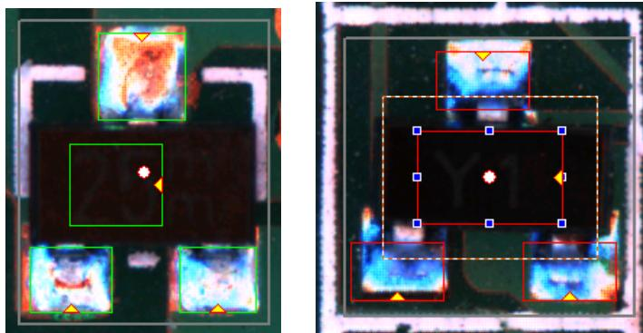
单边脚：多框，多个同样形状的元件脚焊点；
