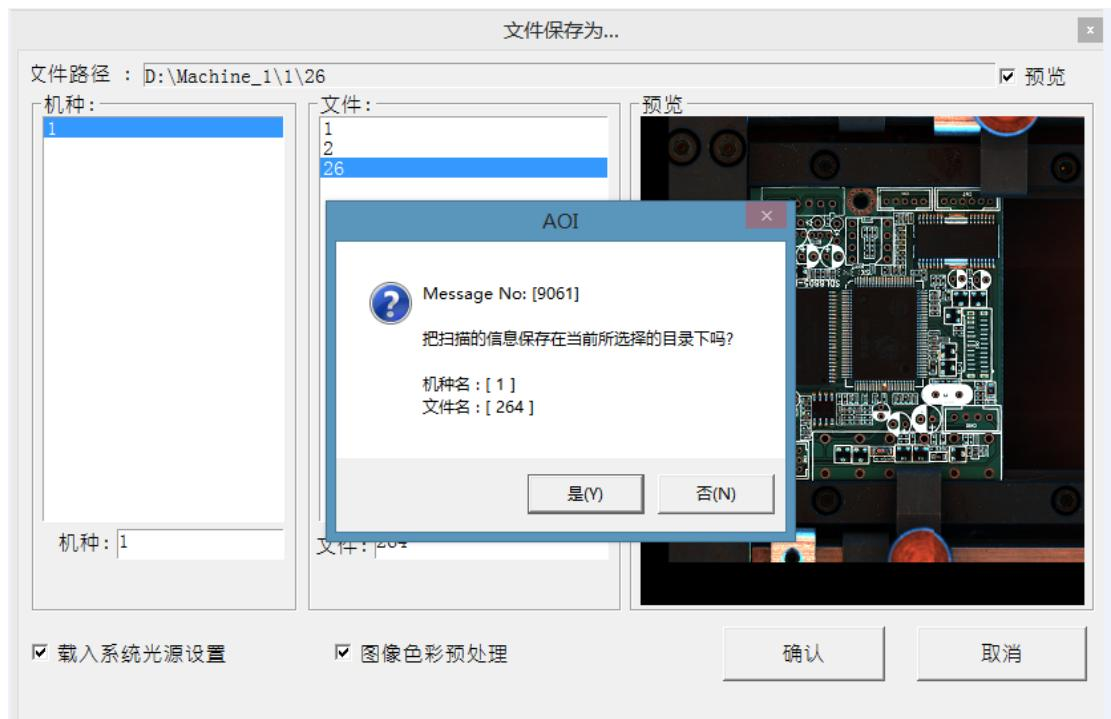
相机开始扫描整个 PCB 的图像，完成后出现对话框提示 {请设定 Mark 点} {Please teach Fiducial Mark}，点击 [确认]，出现设定 Mark 点的对话框：
