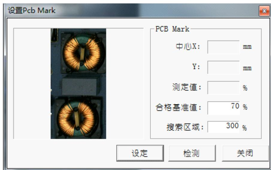
在 PCB Mark 完成设置后，用户通过按“设定 Mark”进入设定 mark 点功能，除了增加了一些 Mark 点检测参数外，Mark 点设定方法和 PCB mark 相仿，一块 PCB 板检测程序
