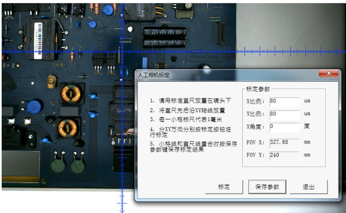
标定分为 X, Y, 方向和相机角度偏差。因为检测时机器的摆放都会有一定角度误差而且系统有一定的角度校正功能，因此相机角度标定实际意义并不大，通常简单设为 0 度，不需特别标定。而 X, Y 方向则需分别标定。
