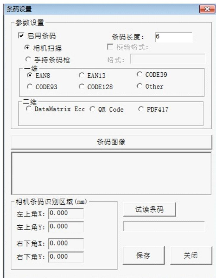
在条码设置窗口中选择启用条码，并设置条码长度。用户可以选择两种不同的扫描模式：手持条码枪和相机扫描。
