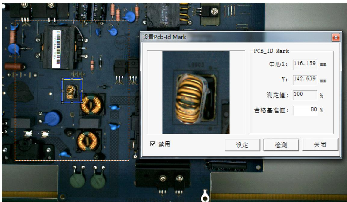
从主菜单中点击进入此功能进行 ID mark 设置和禁用，设置方式很简单，框选特征点，设置合格基准值，试检测，然后退出即可。
